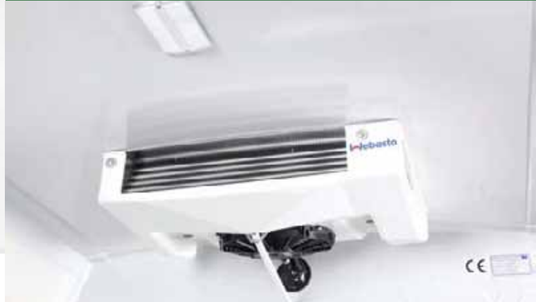
Deckenleuchte und Verdampfer Webasto
